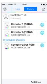
Sie können den Wifi Controller auch von unterwegs (Remote Funktion) per Smartphone oder Tablet steuern. Hierzu müssen Sie bei der Auswahl der Controller oben die Taste „REMOTE“ drücken und können nun die Controller wie gewohnt ansteuern. Diese Funktion ist nur verfügbar, falls der oder die Wifi Controller Ihrem Heimnetzwerk untergeordnet sind. Im Remote Betrieb können nicht die ganze Gruppen (falls vorher definiert) sondern lediglich die einzelnen Controller angesteuert werden.
